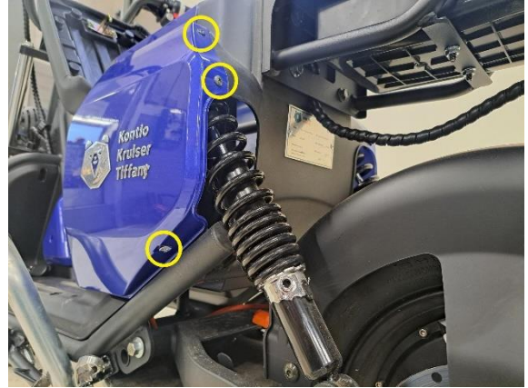
Irrota istuimen vasemmanpuoleisen alasivumuovin kiinnitysruuvit (ristipäämeisseli ph2).
