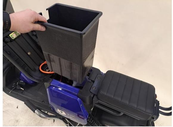
Nosta akkukotelo pois.
