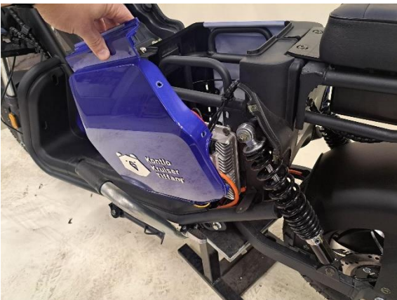
Ota istuimen vasemmanpuoleinen alasivumuovi pois.
