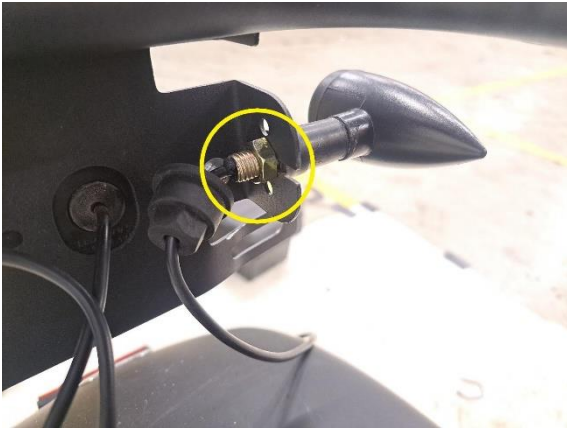
Irrota takavilkun kiinnitysmutteri (kiintoavain 14 mm).
