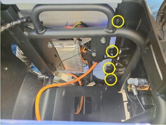
Irrota istuimen vasemmanpuoleisen alasivumuovin kiinnitysruuvit (ristipäämeisseli ph2).
