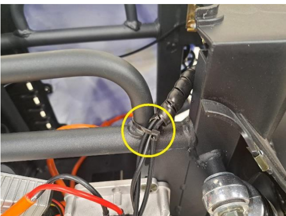
Katkaise takavalojen johtoja kiinni pitävä nippuside (sivuleikkurit).
